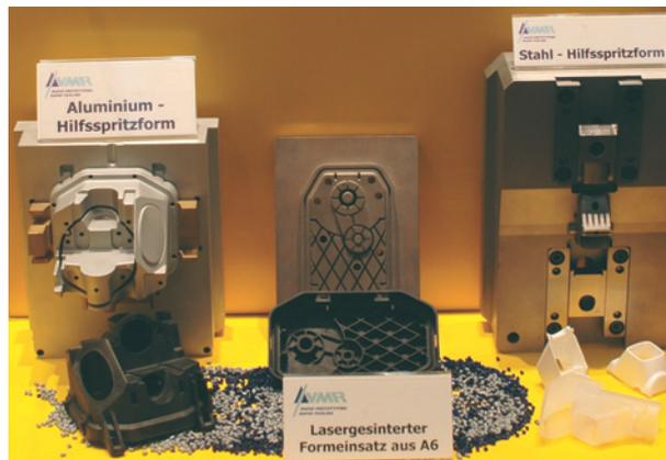
**Auf dem Weg zum Standard:** Per Metall-Laser-schmelzen generierte Formeinsätze, wie hier bei VMR Rapid Tooling, Mönchweiler, ermöglichen ganz andere Formen und machen deren Fertigung noch schneller.
